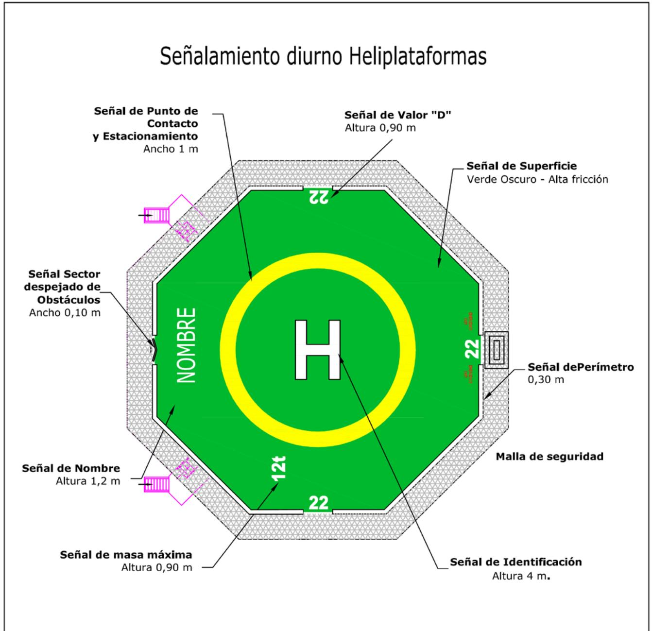
Figura A-4 – Señalamiento diurno tipo para Heliplataformas
