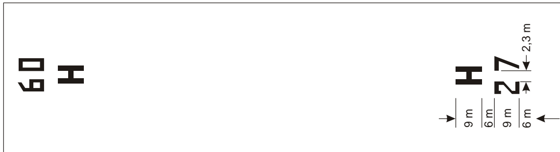
Figura 5-2. Señal de designación de la FATO y señal de identificación de helipuerto para FATO de tipo pista de aterrizaje
