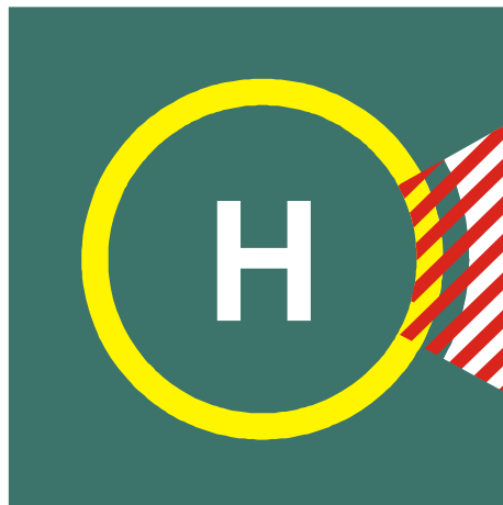
Figura 5-7. Señal de sector de aterrizaje prohibido en la heliplatforma
