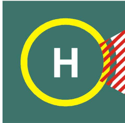
**Figura E-13. Señal de sector de aterrizaje prohibido en la heliplatforma**
