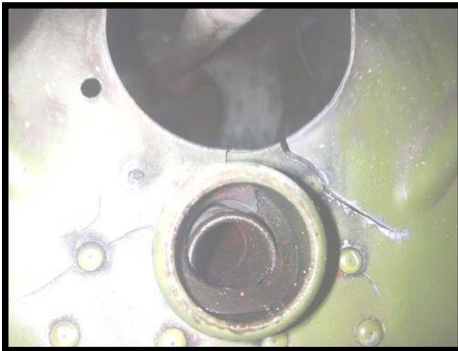
El acceso a esta cuaderna para su inspección, se logra mediante el retiro del *Stinger* (ítem 1 de la Figura 39 del IPC). Una vez retirada esta parte, a través del orificio por donde pasa el patín, se puede observar la cuaderna a inspeccionar.
