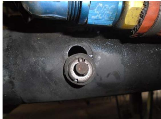
En enero de 2017 se recibió en el DAG un nuevo Informe, en el que se informa de detección de la misma novedad durante la aplicación de la Advertencia 128/DAG. En las siguientes fotografías se puede apreciar el daño en la caja de aire.
