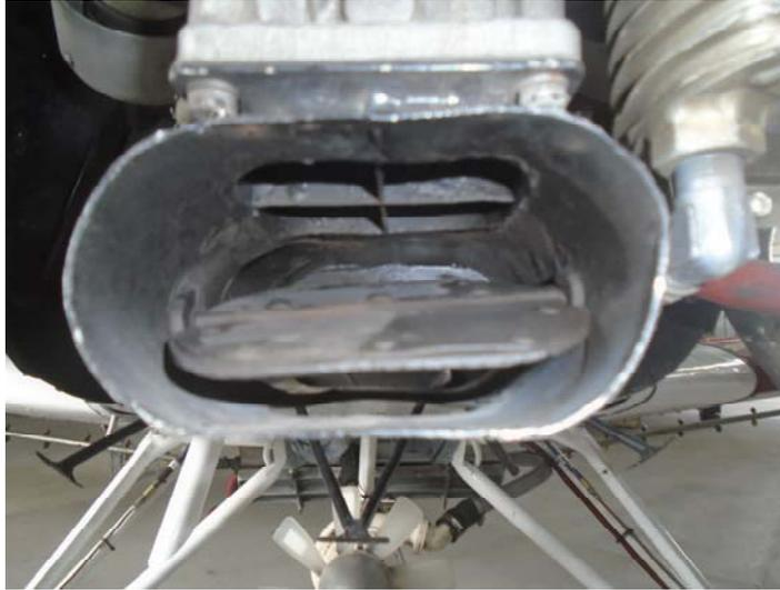
Véase que la placa no llega a ubicarse en la posición correcta, dado que al actuar el comando de Aire Caliente a la posición cerrado, empuja el brazo del eje de la placa hacia adelante, produciendo que el eje se cruce trabándose la palca en esta posición.
