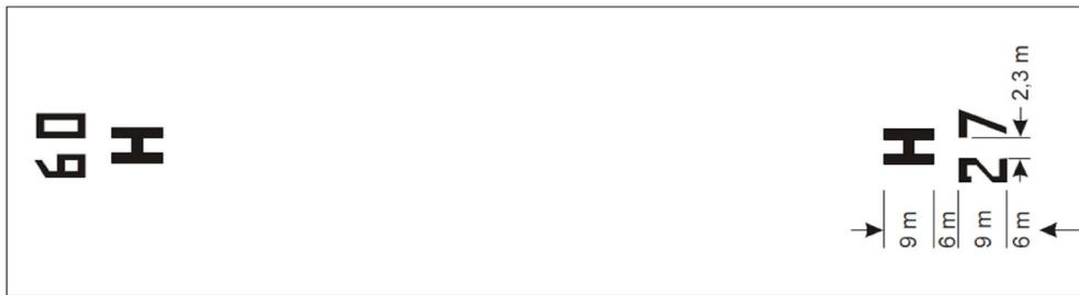
**Figura E-4 Señal de designación de la FATO y señal de identificación de helipuerto para FATO de tipo pista de aterrizaje**
