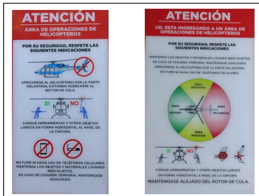
Figura C-9(B). Ejemplos de tipos de señalética de seguridad para el personal utilizada en helipuertos
